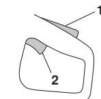
Cuando se suelta la empuñadura, el acelerador y el fiador del acelerador vuelven a sus respectivas posiciones iniciales. En esta posición, la máquina se detiene y el acelerador se bloquea, mientras que la válvula de agua vuelve a la posición cerrada.
