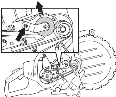
**ATTENTION!** Vérifier que les deux poulies sont propres et en bon état avant de monter une nouvelle courroie d' entraînement.
