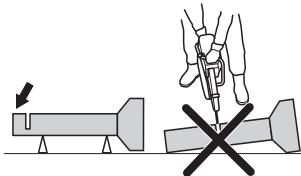
Si le tuyau peut pendre et fermer la coupe, la lame risque d'être pincée dans la zone de rebond et cela peut susciter un rebond important.
