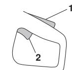
Lorsque la prise sur la poignée est relâchée, la commande d'accélération et le blocage de l'accélération reviennent en position initiale. Dans cette position, la machine s'arrête, l'accélérateur se verrouille et la valve d'eau revient en position fermée.
