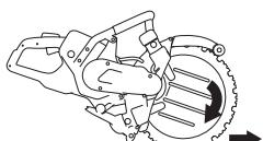
No traslade la máquina cuando el equipo de corte gira. Las fuerzas giroscópicas pueden obstaculizar el movimiento deseado.
