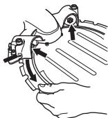
**REMARQUE!** La machine doit être à la verticale. Si la machine est couchée sur le côté, le poids de la lame rend un réglage correct difficile. Un réglage incorrect peut endommager la lame. Si la lame tourne lentement ou s'arrête, interrompre immédiatement la coupe et rechercher la panne.
